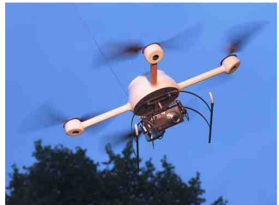
Die MD4-200 von Microdrones kann 20 Minuten fliegen. Gut sichtbar: die Kamera.
